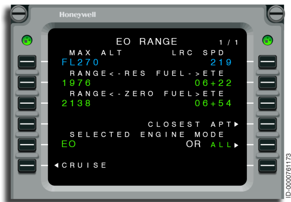
Figure 14-2 EO RANGE - EO Confirmed
